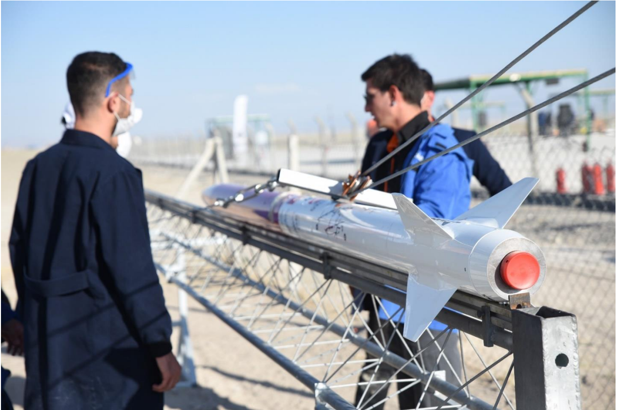
Görsel. Roketin Rampaya Yerleştirilmesi
